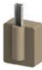
Hincado con pre-taladro
